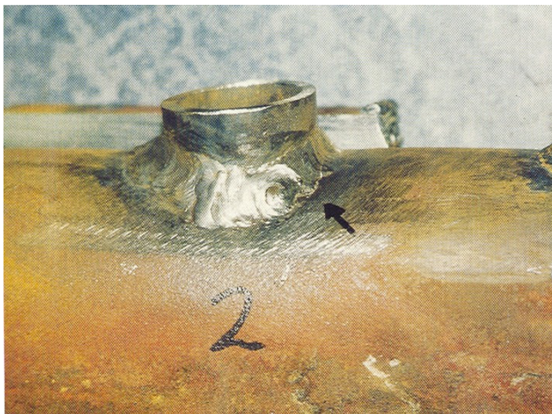
Interkristalline Riss im Wärmeeinflusszone der Schweißnaht In den Rissen wurden Kupferausscheidungen detektiert. Infolge der Schweißen dringte Kupfer zwischen die Austenitkörner und verursachte dort Risse.
