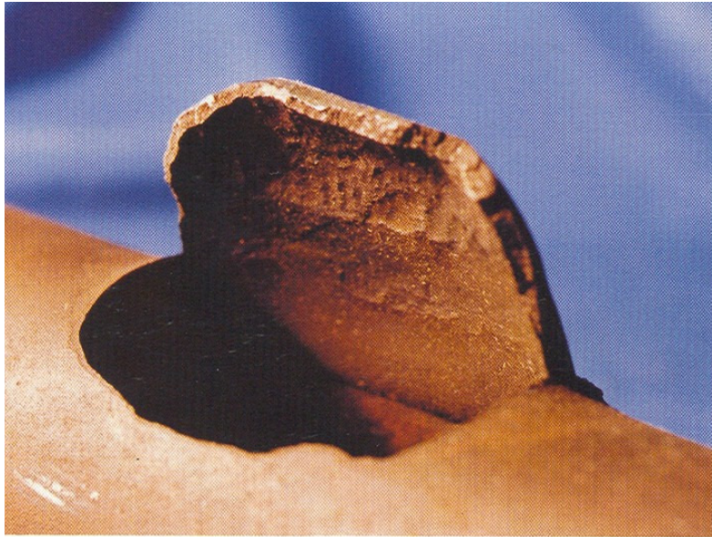
Hochtemperaturkorrosion infolge Wasserstoff Perlitausscheidung und Mikrorisse im Mikrostruktur (Kohlenstahl)
