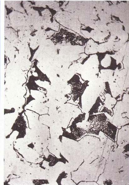
Hochtemperaturkorrosion infolge Wasserstoff Perlitausscheidung und Mikrorisse im Mikrostruktur (Kohlenstahl)
