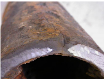
Gusseisen Trinkwasserleitung Matrix im Gusseisen wurde ausgelöst Grafit blieb R_m=0 MPa
