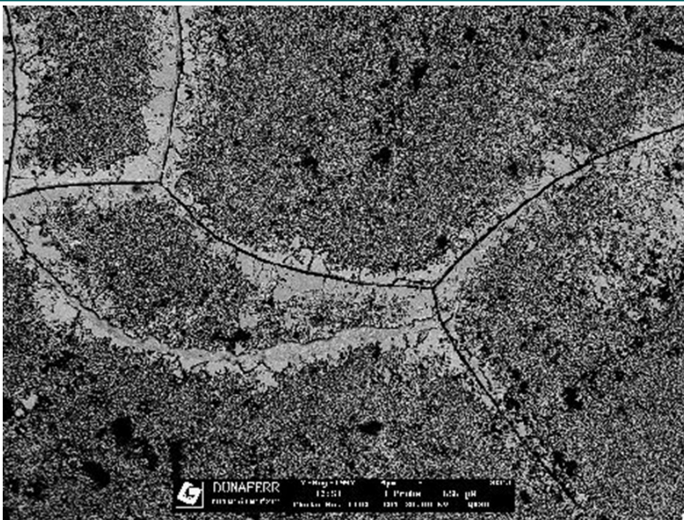
Interkristalline Korrosion einer ferritische korrosionsbeständigen Stahl
