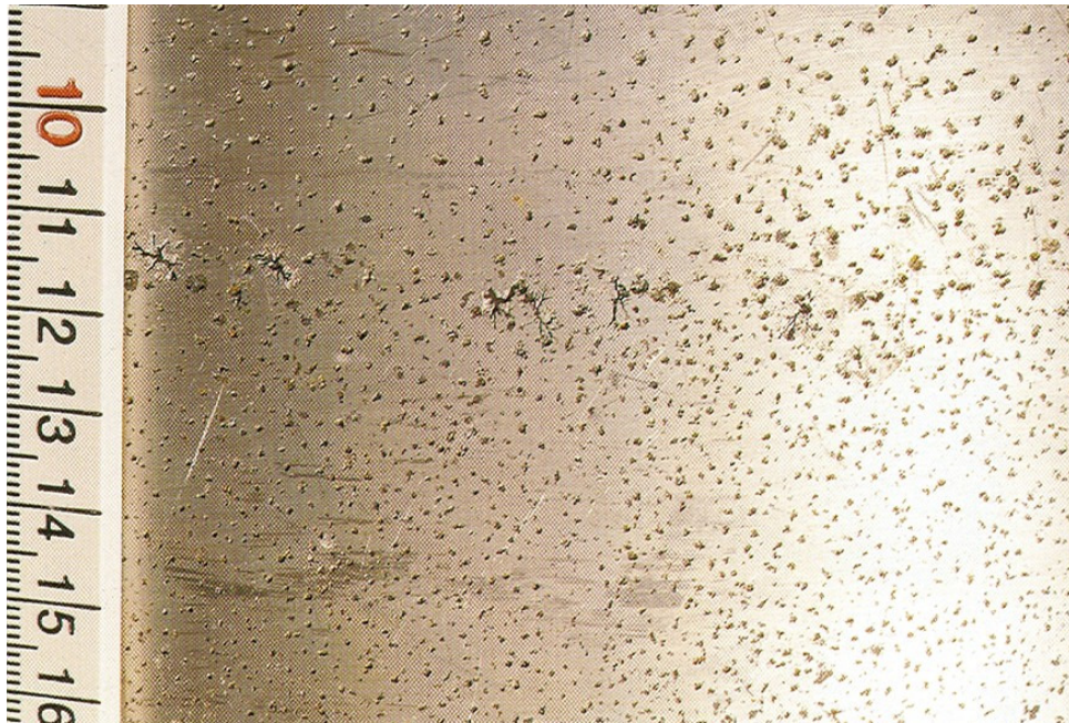
Korrosion von korrosionsbeständigen Stahl induziert durch Kloridionen, mit lokalen Rissen die auf Spannungskorrosion deuten ( \text{Cl}^- haltiges Trinkwasser)
