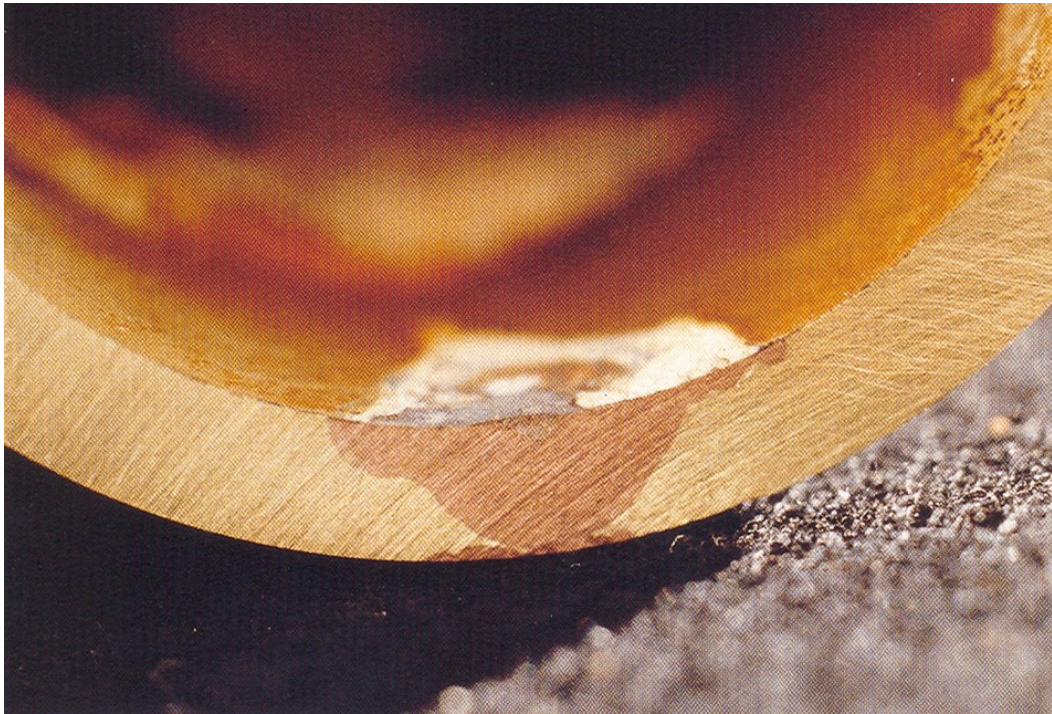
Kleines Zn-haltigen Messing (Cu+Zn) in säurigen Medium Verminderung der Zn-Gehalt unter die Ablagerung
