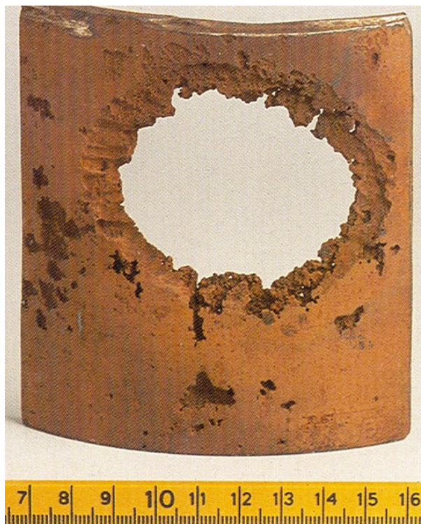
Kavitationskorrosion von Karbonstahl, durch reduziertes Dampf mit 0,15 MPa Druck
