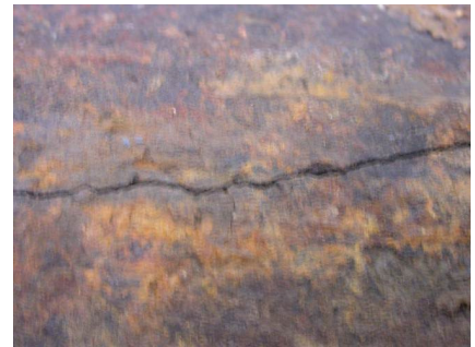
Gusseisen Trinkwasserleitung Matrix im Gusseisen wurde ausgelöst Grafit blieb R_m=0 MPa
